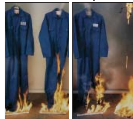
> Combinaisons ignifugées et non ignifugées. Dans une première phase, la combinaison ignifugée résiste au feu, dans une deuxième phase, la combinaison non ignifugée a complètement brûlé - Source Thor.
